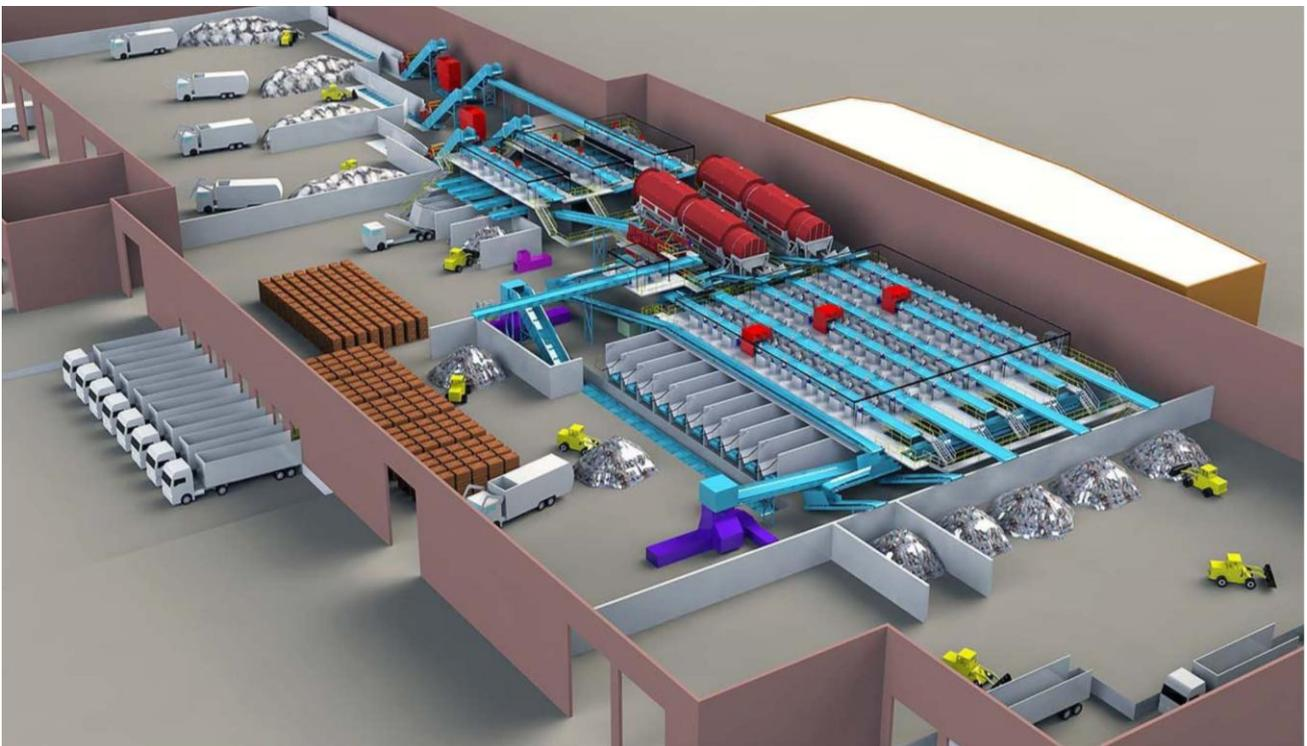
La figura superior muestra un esquema de una Planta Separadora de Basura.
